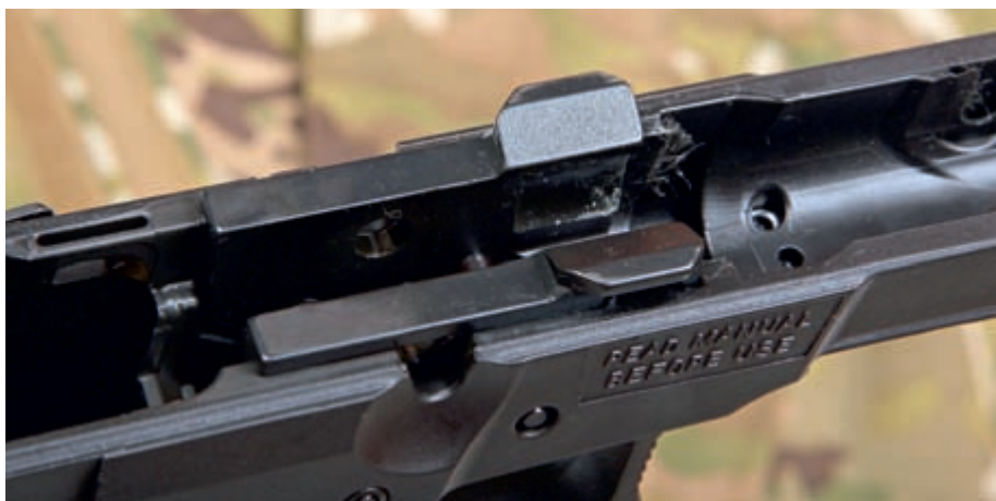
Sopra: la gondola anteriore supporta il grilletto e ha una coppia di guide per lo scorrimento del carrello.
