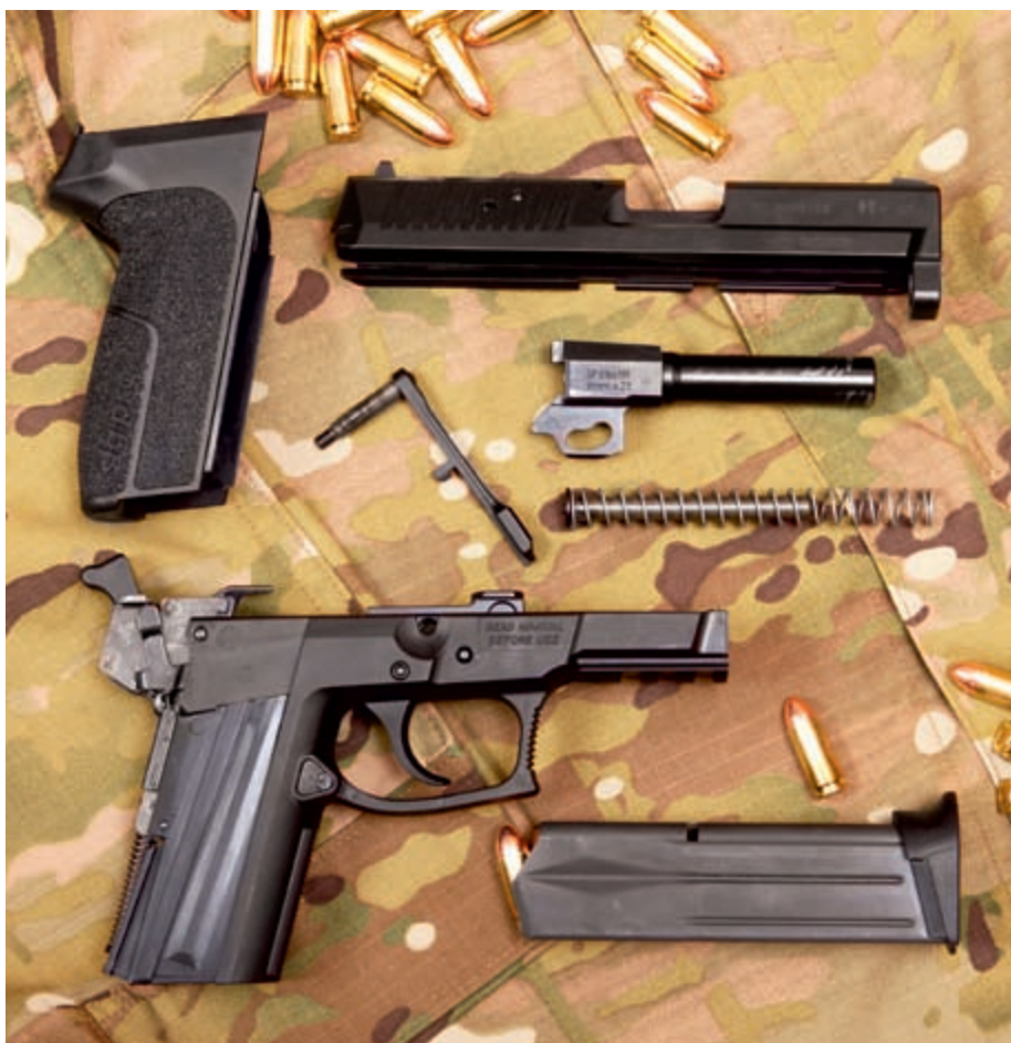
Sotto: lo smontaggio è semplice e razionale, come si conviene a un'arma destinata al law enforcement.
